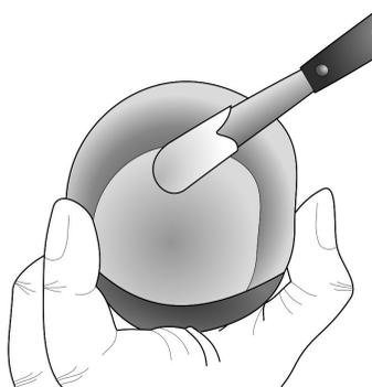
6) Se van depositando "nueces" de la mezcla sobre la impresión "semi-seca" (se vibra la mezcla y se vibra la cubeta mientras se rellena):
