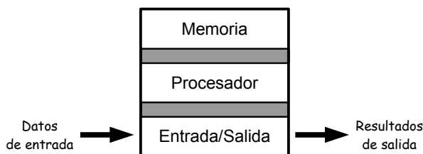
Figura 1.3 Esquema general de un computador.
