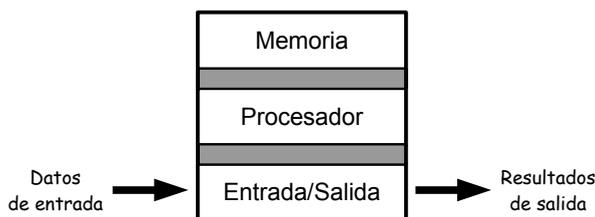
Figura 1.3 Esquema general de un computador.
